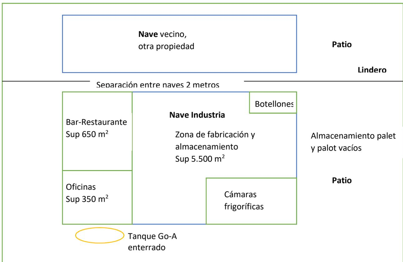
→ Las cámaras frigoríficas tienen un grupo compresor con una potencia eléctrica total de 50 kW, con 100 kg de hexafluoruro de azufre de refrigerante.
