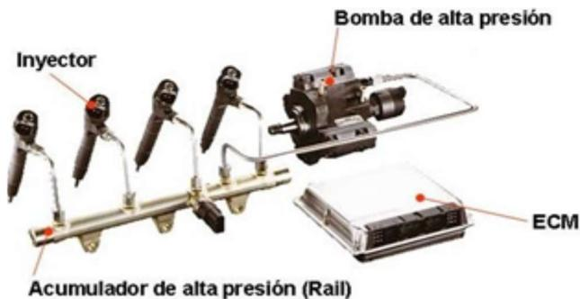
Si la presión de combustible en el circuito de alta presión es de 300 bar, pero el motor no arranca, ¿qué comprobaríamos en primer lugar?
